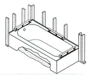
5. Placez la baignoire à l'endroit souhaité et assurez-vous qu'elle soit de niveau et d'aplomb. Ajustez les pieds ou ajoutez des cales si nécessaire. Le poids de la baignoire doit reposer sur ses pieds. Veillez à ce que le lit de mortier soit en contact avec toute la surface de la cuve.
