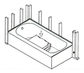
6. Fixez la baignoire au mur à l'aide de vis galvanisées aux emplacements pré-percés. Appliquez un poids au centre de la baignoire jusqu'à ce que le mortier prenne.
