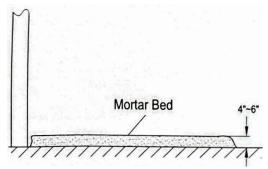
4. Versez une couche généreuse (10 à 15 cm) de mortier de ciment sur la zone où sera installé votre bassin de baignoire. Veuillez noter qu'en raison de la pente de la baignoire, il est nécessaire d'appliquer une couche plus épaisse du côté opposé à la bonde. Assurez-vous de recouvrir la bonde pour éviter que du mortier ne tombe à l'intérieur. Laissez également la zone où reposeront vos pieds exempte de mortier.
