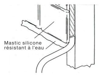
8. Installez des plaques de plâtre résistantes à l'eau et un revêtement de surface (carrelage, pierre), puis scellez tous les bords avec du mastic silicone pour éviter les dégâts d'eau.
