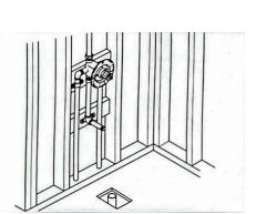
3. Retirez la baignoire et installez le drain, prépercez des trous sur la bride de carrelage à l'emplacement marqué des montants.
