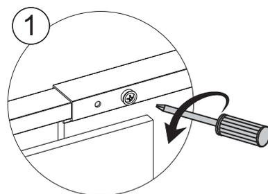
Desserrez les vis et le rail de guidage télescopique peut être ajusté en taille.
