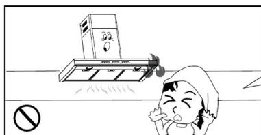
Ne pas raccorder la sortie d'air aux conduits de cheminée ou aux conduits de gaz de combustion.
